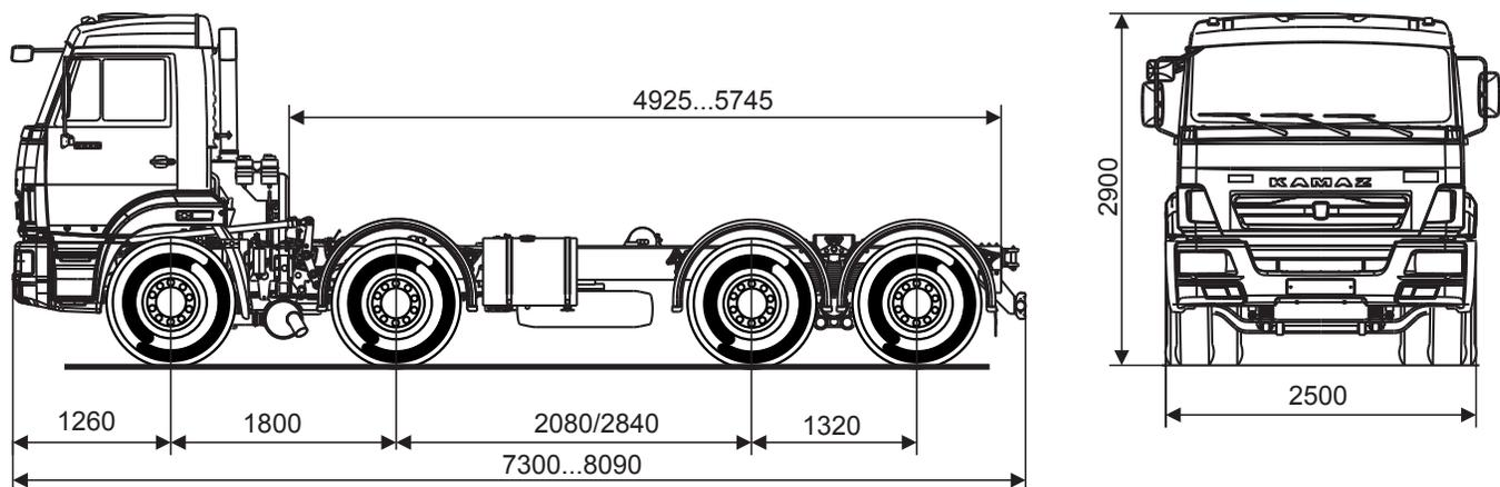
Размеры даны для шасси снаряженной массы
