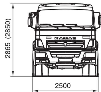
Размеры даны для шасси снаряженной массы с шинами 11R20
