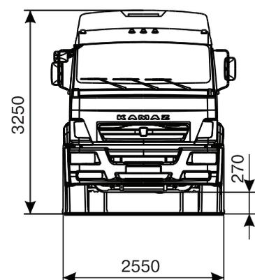
Размеры даны для шасси снаряженной массы
