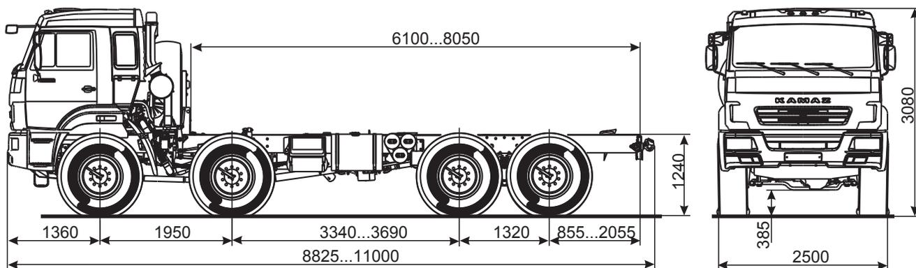
Размеры даны для шасси снаряженной массы
