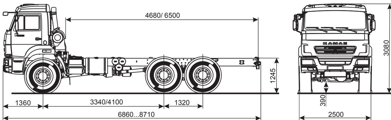
Размеры даны для шасси снаряженной массы
