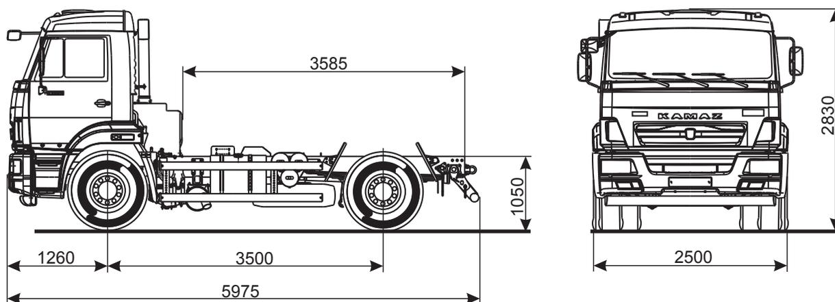
Размеры даны для шасси снаряженной массы
